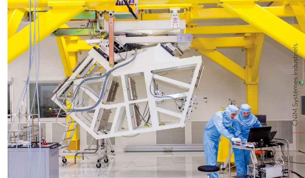
Système de manutention des systèmes de conversion de fréquence et de focalisation (SCF) du LMJ permettant le positionnement des miroirs à quelques µm près, compatible ISO7, chargement de plusieurs tonnes.
