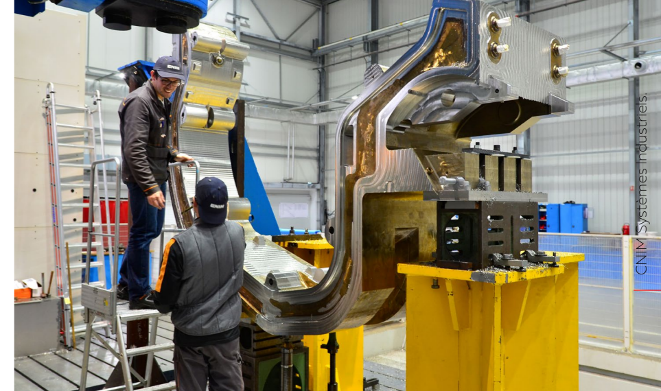
Prototype du divertor cassette body du tokamak ITER 3,3x2,5x0,8m - 316LN & XM-19
