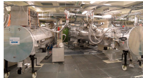
Systèmes d'insertion des diagnostics : outillages pour insertion au sein du LMJ de différents types de diagnostics du plasma. Contrôlés à distance, les SID fonctionnent sous vide interne
