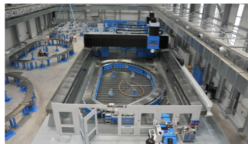
Fabrication série de 35 structures de bobine de champ toroidal d'ITER. Soudage par faisceau d'électron sous vide local.
