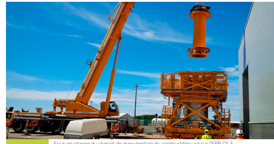
Essai en charge du chariot de manutention du combustible usé sur l'EPR OL3
