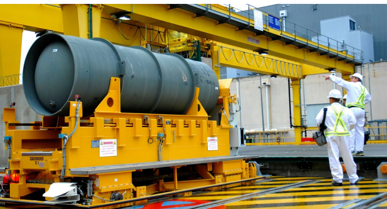
Système de manutention de l'uranium enrichi (usine GBII)
