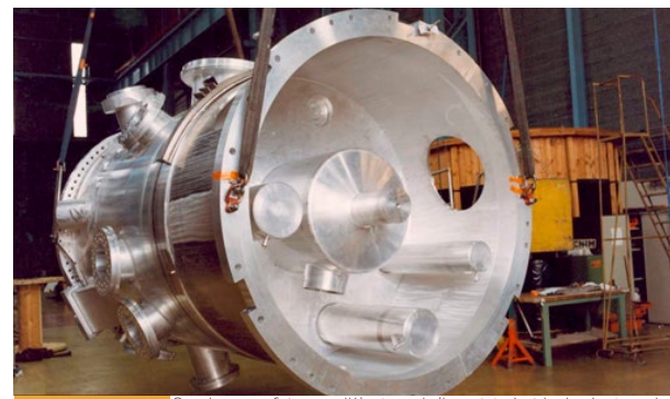
Soudage par faisceau d'électron de l'enceinte à vide du réacteur de la source expérimentale de neutrons Heinz Maier-Leibnitz (FRMII)
