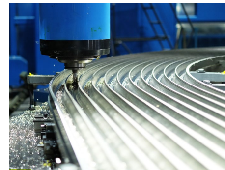
Fabrication série de 35 plaques radiales pour ITER
