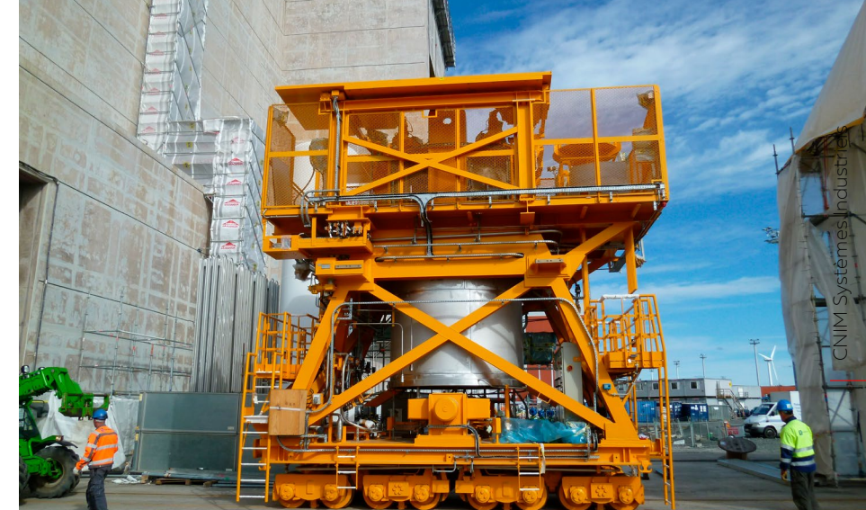
Chariot de chargement et déchargement du combustible usé de l'EPR OL3 en Finlande
