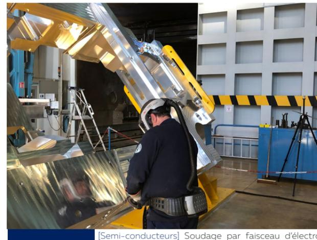
[Semi-conducteurs] Soudage par faisceau d'électron d'un châssis complexe de machines.
