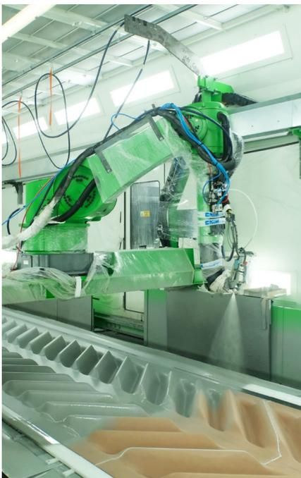
Pulvérisation robotisée de polyuréthane.
