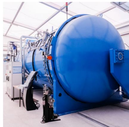
Four autoclave pour les pièces en composite.
