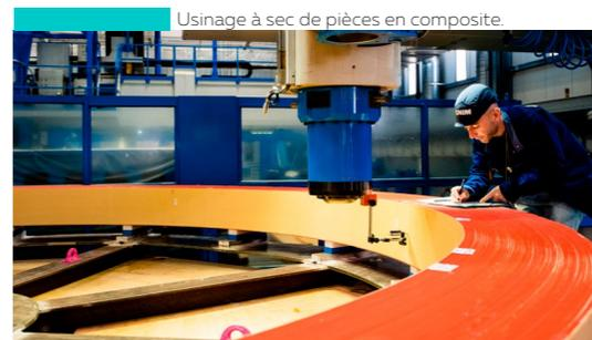
Usinage à sec de pièces en composite.
