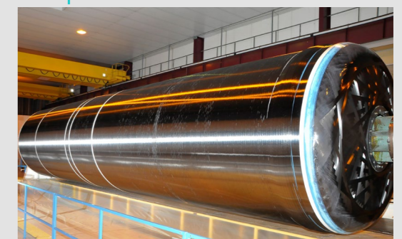
Structure bobinée avec éléments internes en polyuréthane
