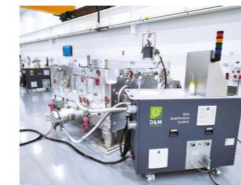
Test de dégazage (RGA : residual gaz analysis)
