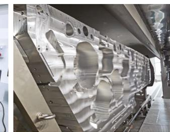
Châssis dans machine à laver en salle grise
