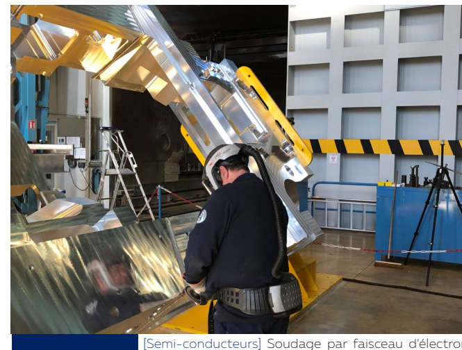
[Semi-conducteurs] Soudage par faisceau d'électrons d'un châssis complexe de machines.
