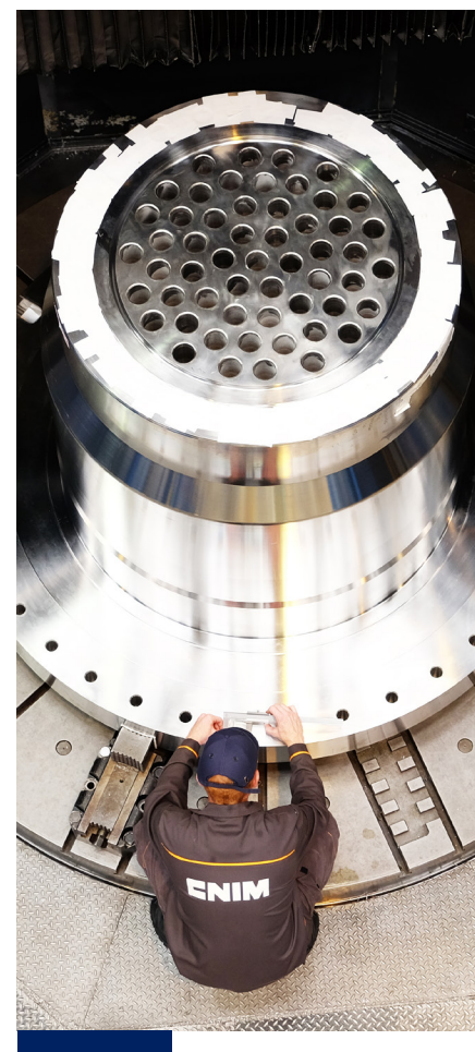
Les assemblages les plus complexes et exigeants sont réalisés en salle blanche ISO 6.
