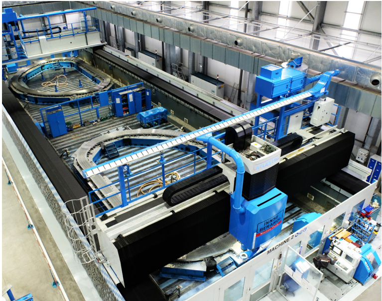
Fraiseuse double portique (X 30000, Y 9000, Z 1250 mm, charge max. : 5 tonnes / m²).
