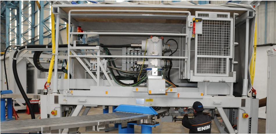
Le soudage sous vide local : parfait pour les pièces de très grande dimension.
