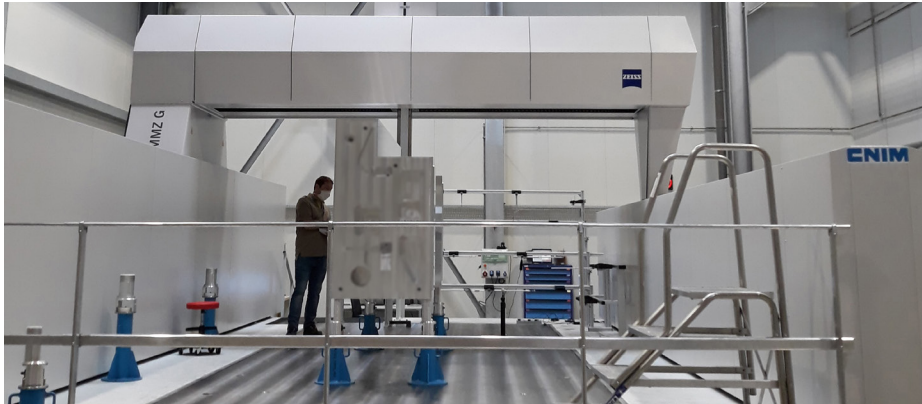
Contrôler au 10 ème de millimètre près avec la machine ZEISS MMZ-G. (X 4000 Y 8000 Z 2000 mm).
