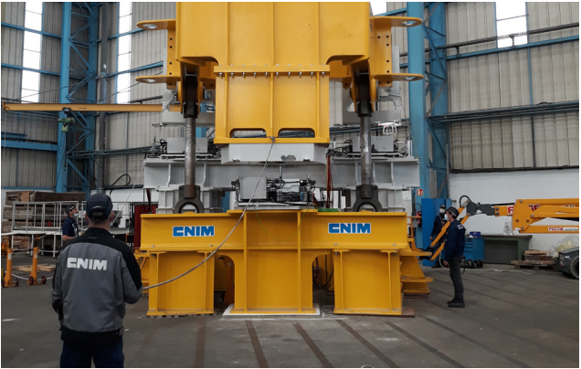
Tester un outillage de montage de composants pour le réacteur de fusion ITER.
