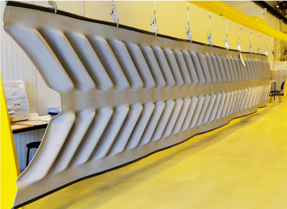
Morceau de membrane assurant l'étanchéité du nouveau sarcophage de la centrale de Tchernobyl.
