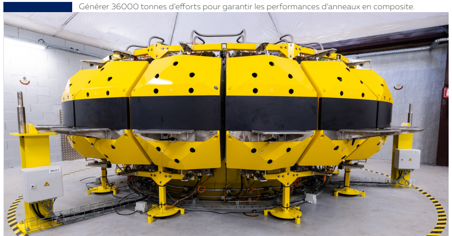
Tester un outillage de montage de composants pour le réacteur de fusion ITER.
