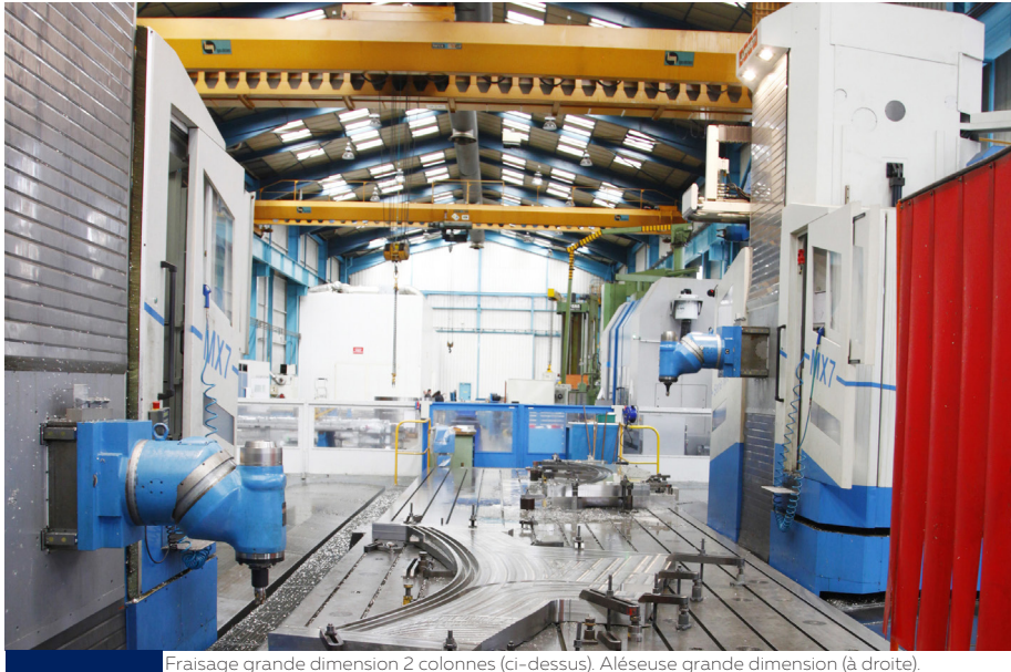
Fraisage grande dimension 2 colonnes (ci-dessus). Aléuseuse grande dimension (à droite).
