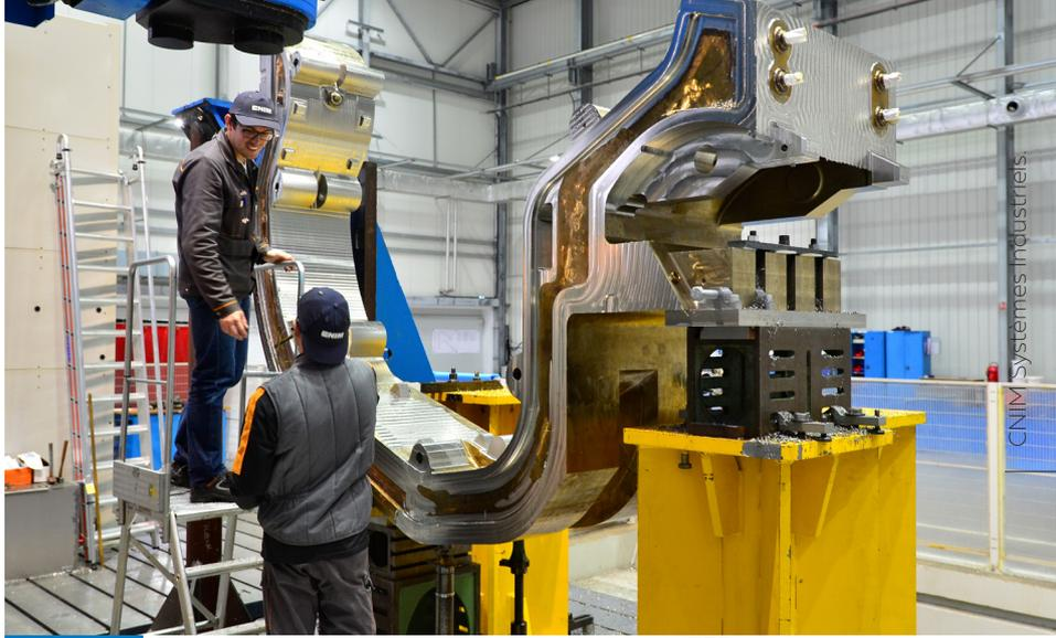
Prototype du divertor cassette body du tokamak ITER
