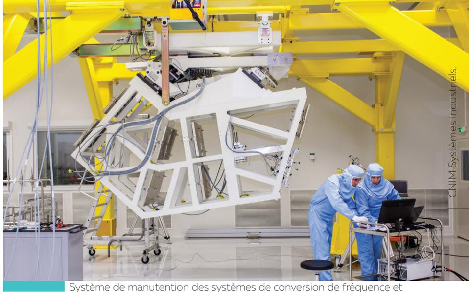
Système de manutention des systèmes de conversion de fréquence et de focalisation (SCF) du LMJ permettant le positionnement des miroirs à quelques  $\mu\text{m}$  près, compatible ISO7, chargement de plusieurs tonnes.
