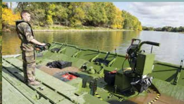
Le Pont Flottant Motorisé (PFM) est **une solution dédiée au franchissement continu ou discontinu de brèches humides pour les véhicules militaires lourds de classe MLC 90C/100R** (selon les standards FINABEL et STANAG 2021). Il est également adapté pour un usage civil lors d'opérations de sauvetage à la suite de catastrophes naturelles par exemple.
