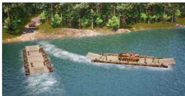
**MLC 90C, manœuvrable à 360°** pour une navigation facilitée en portière. Moteurs haute performance pour une **navigation polyvalente** (longitudinal & transversal)
