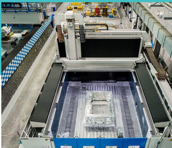
3 000 m<sup>2</sup> d'ateliers climatisés au degré près, dotés de plusieurs tours verticaux et aléseuses, de 3 centres d'usinage grande vitesse et d'une fraiseuse double portique pouvant usiner des pièces jusqu'à 10 m de large et 30 m de long.
