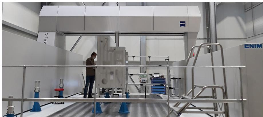
Contrôler au 10<sup>ème</sup> de millimètre près avec la machine ZEISS MMZ-G. ( X 4000 Y 8000 Z 2000 mm).
