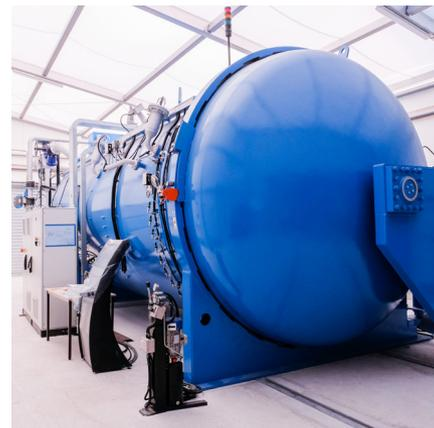
Four autoclave pour les pièces en composite.
