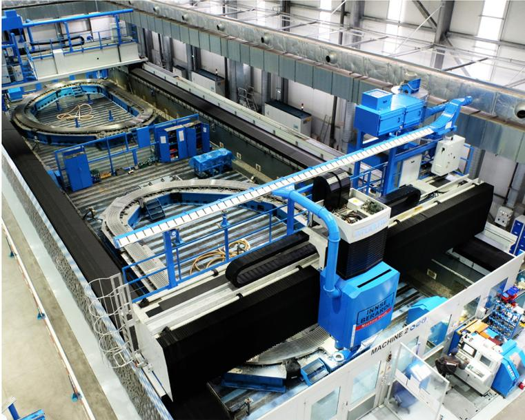
Fraiseuse double portique (X 30000, Y 9000, Z 1250 mm, charge max. : 5 tonnes / m<sup>2</sup>).
