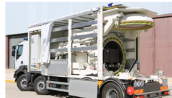
▲ 13kilos Eq. TNT : résistance de la cuve
